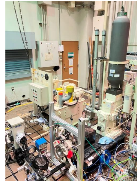
着火・燃焼特性評価装置 (RCM:急速圧縮膨張装置)
