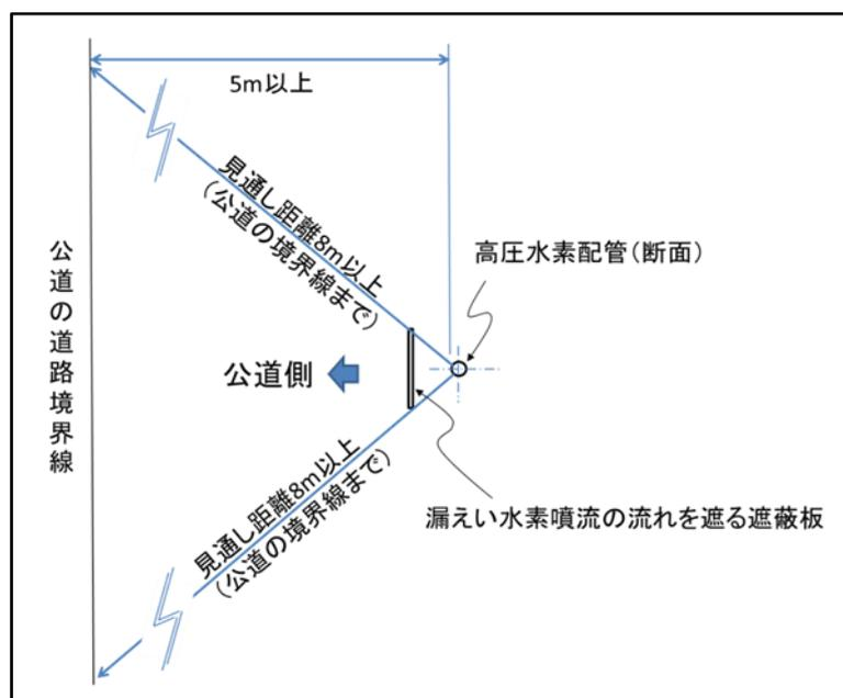
水素噴流によって遮蔽板に作用する力は軽微である。よって、「水素噴流によって遮蔽板が吹き飛ばす・変形する」等の観点からの強度や固定方法等に対する配慮は不要である。
