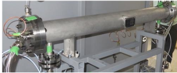
図 4. 試験用熱交換器装置の外観
