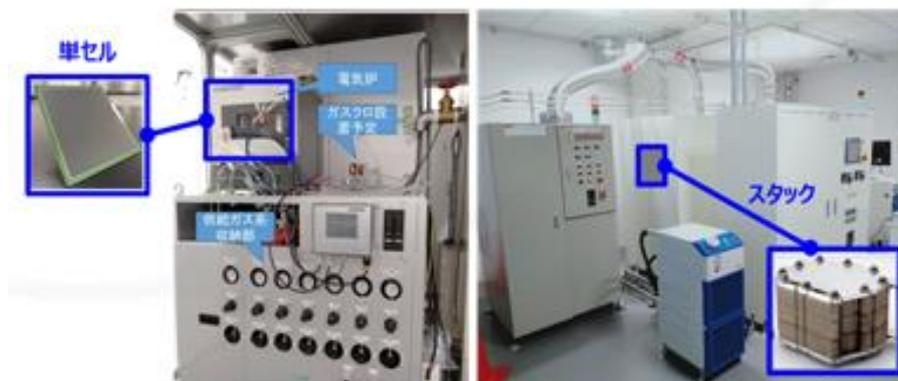
図 3 セル電解評価装置 (左) スタック電解評価装置 (右)
