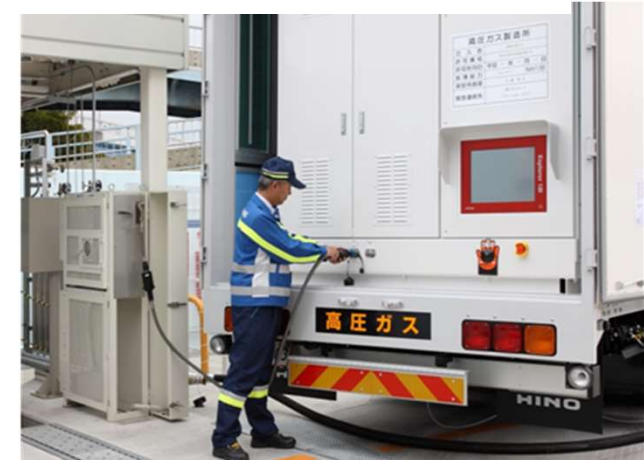
移動式水素スタンドへの充填作業の例
