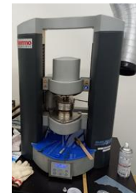
レオメーター せん断速度を変化させながら、粘性率の変化を測定。
