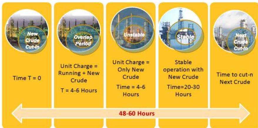
原油種の変更に伴い新しい原油の蒸留塔（CDU）に対する最適化には2日から3日のロスが生ずる。
