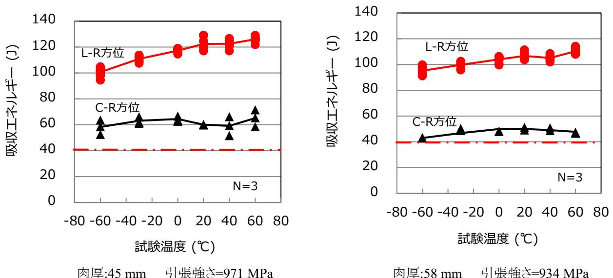
解説図6 SNCM439蓄圧器から採取したシャルピー衝撃試験の事例
