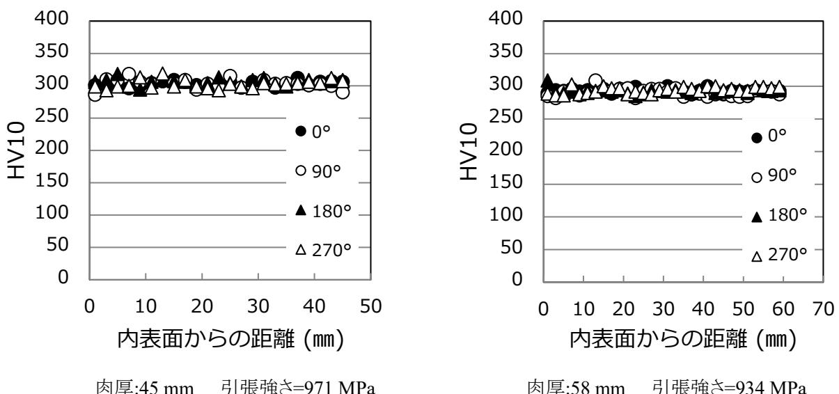
解説図2 SNCM439 蓄圧器から採取した硬さ試験の事例
