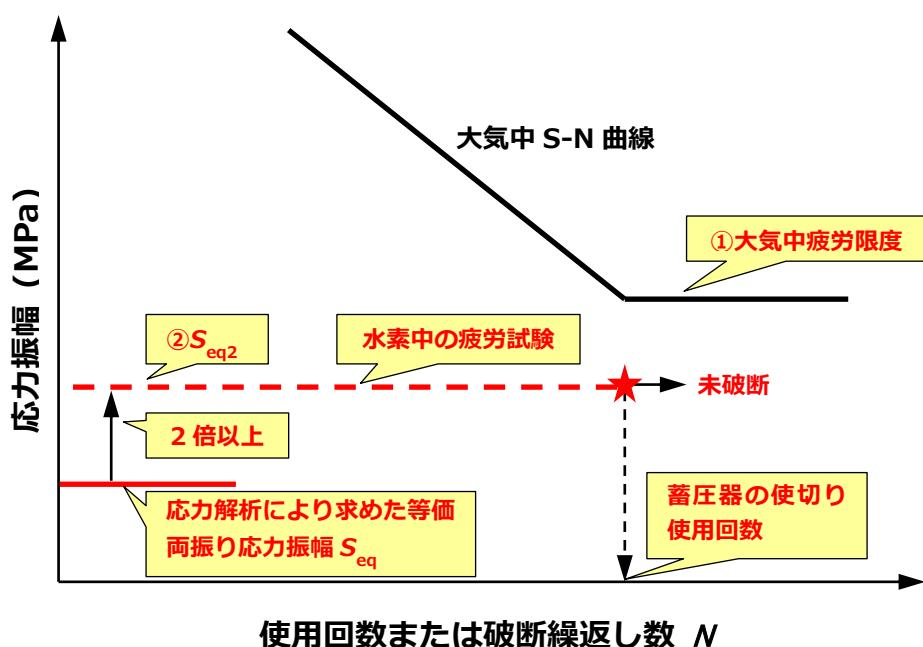
図 A.1 疲労試験による蓄圧器の使切り使用回数設定方法の模式図
