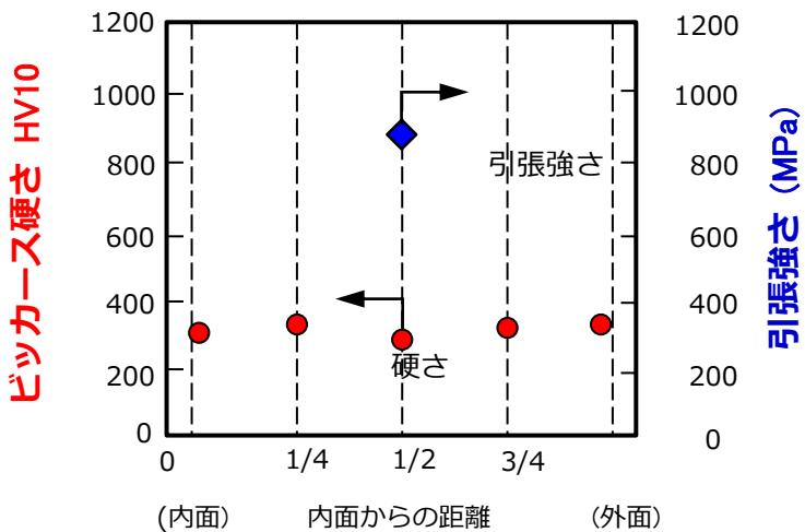
図 4.2 硬さ試験結果の模式図
