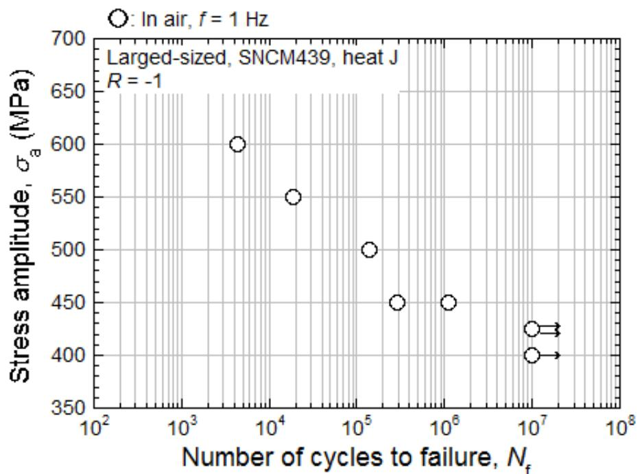
(d) Heat J, tempered at 650 °C ( $\sigma_B=881$  MPa)
