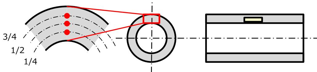
解説図3 引張試験片採取位置
