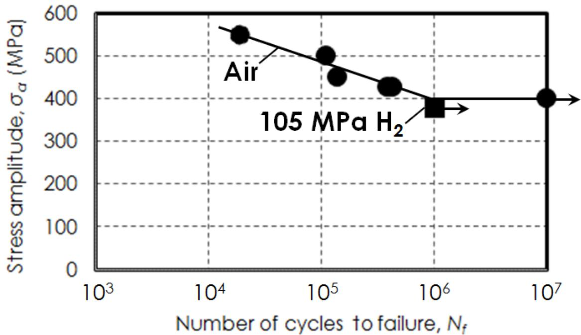
Fig. C.2.3.1 S-N diagram of SNCM439.
