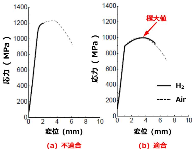
図 4.1 SSRT における応力-変位線図の模式図
