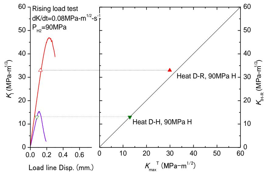
解説図 11 ライジングロード法による  $K_{IH}$  と疲労き裂進展から求めた  $K_{max}^T$  の対比
