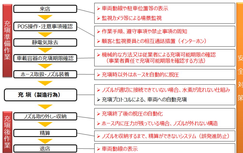
図 2 セルフ充填のために追加した安全対策 (第 10 回水素・燃料電池自動車関連規制に関する検討会資料より抜粋)
