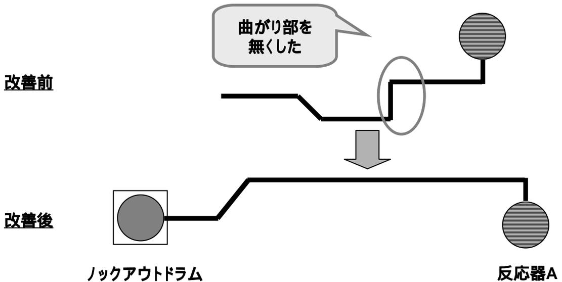
図2 安全弁放出管の改良図
