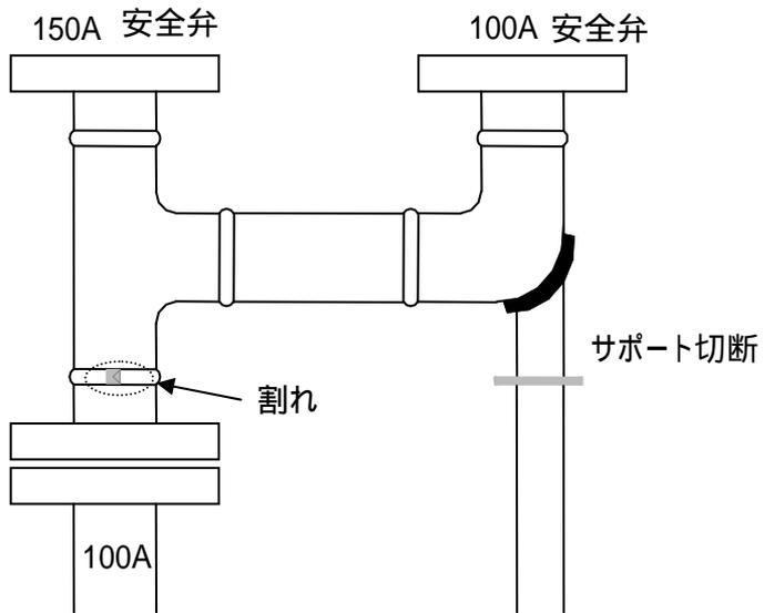
図 安全弁取り出し配管の概要
