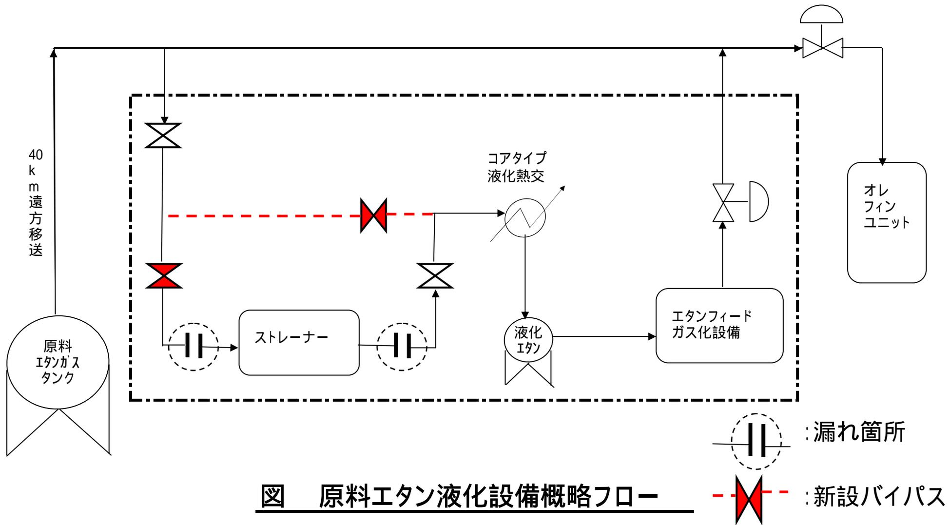
**図 原料エタン液化設備概略フロー**
