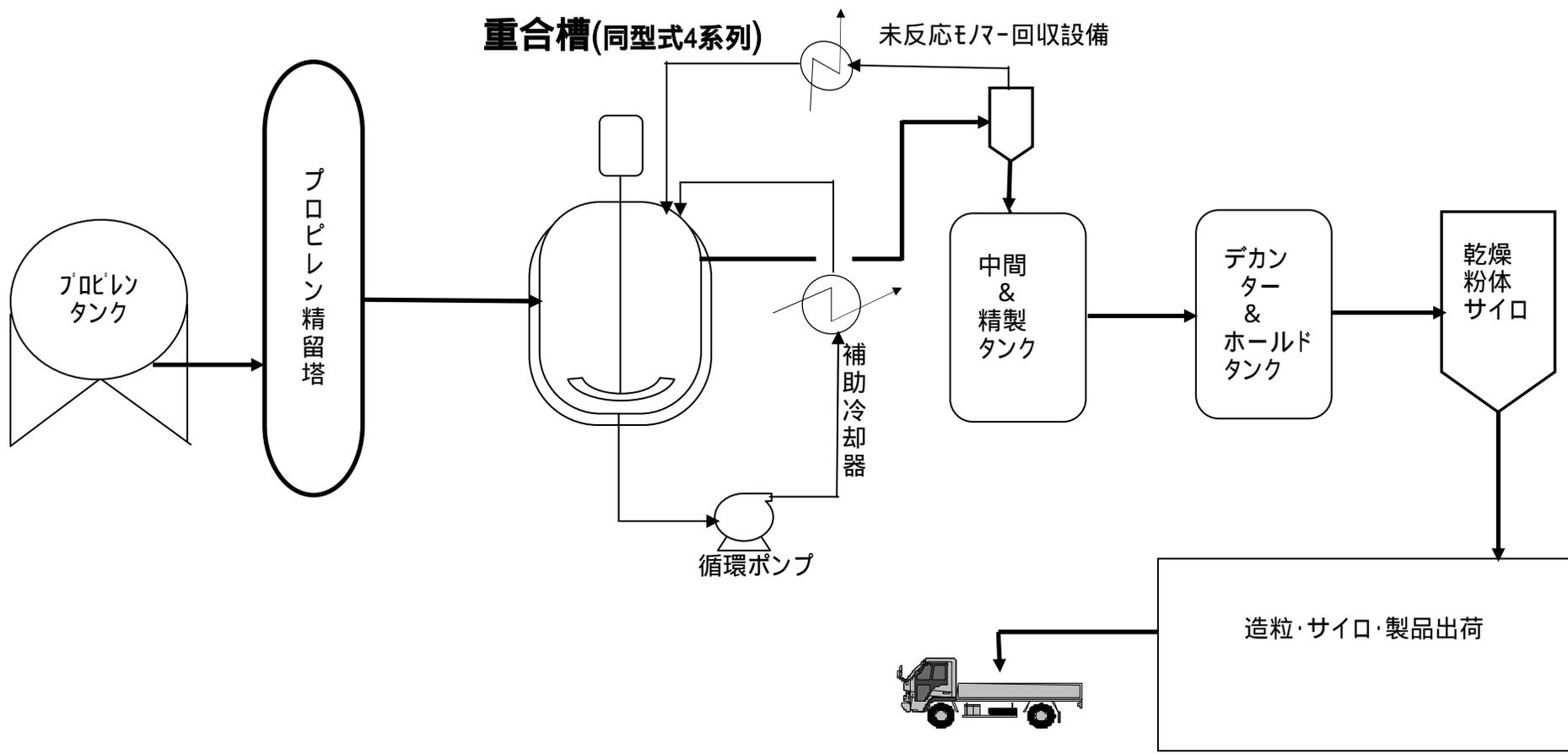
**図 - 1 ポリプロピレン製造装置フローシート**
