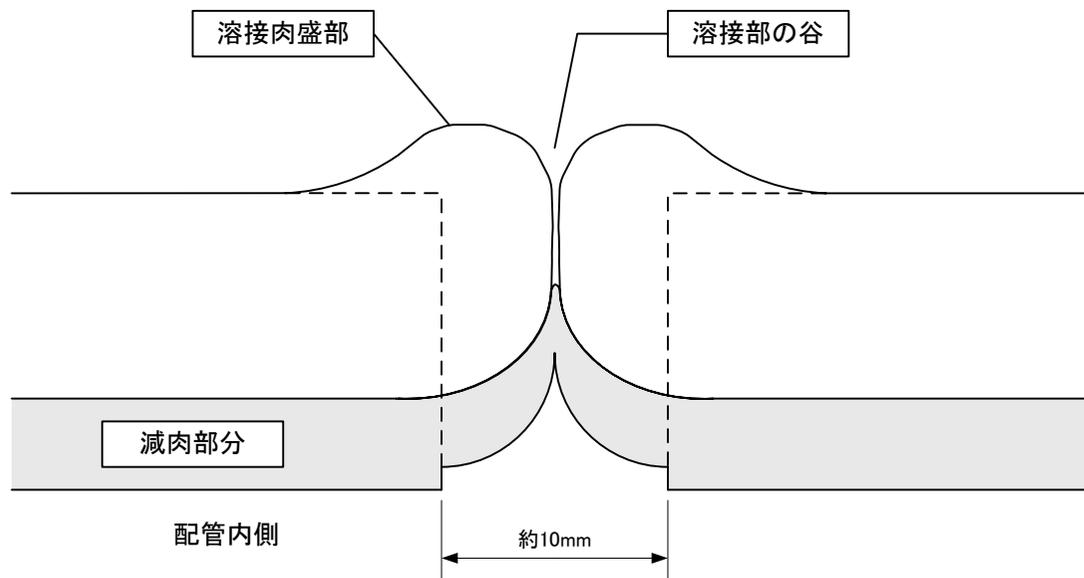
図2 溶接部の穿孔イメージ
