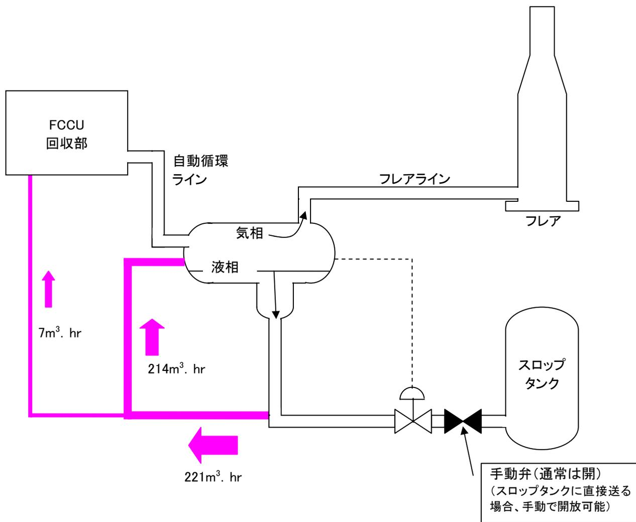
図 3 フレアノックアウトドラムまわり(変更後)
