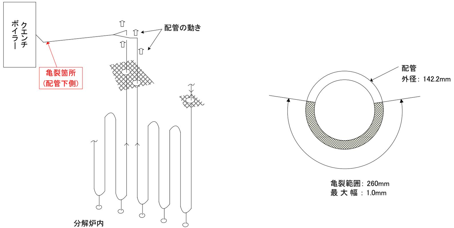
図2 亀裂発生箇所および亀裂状況
