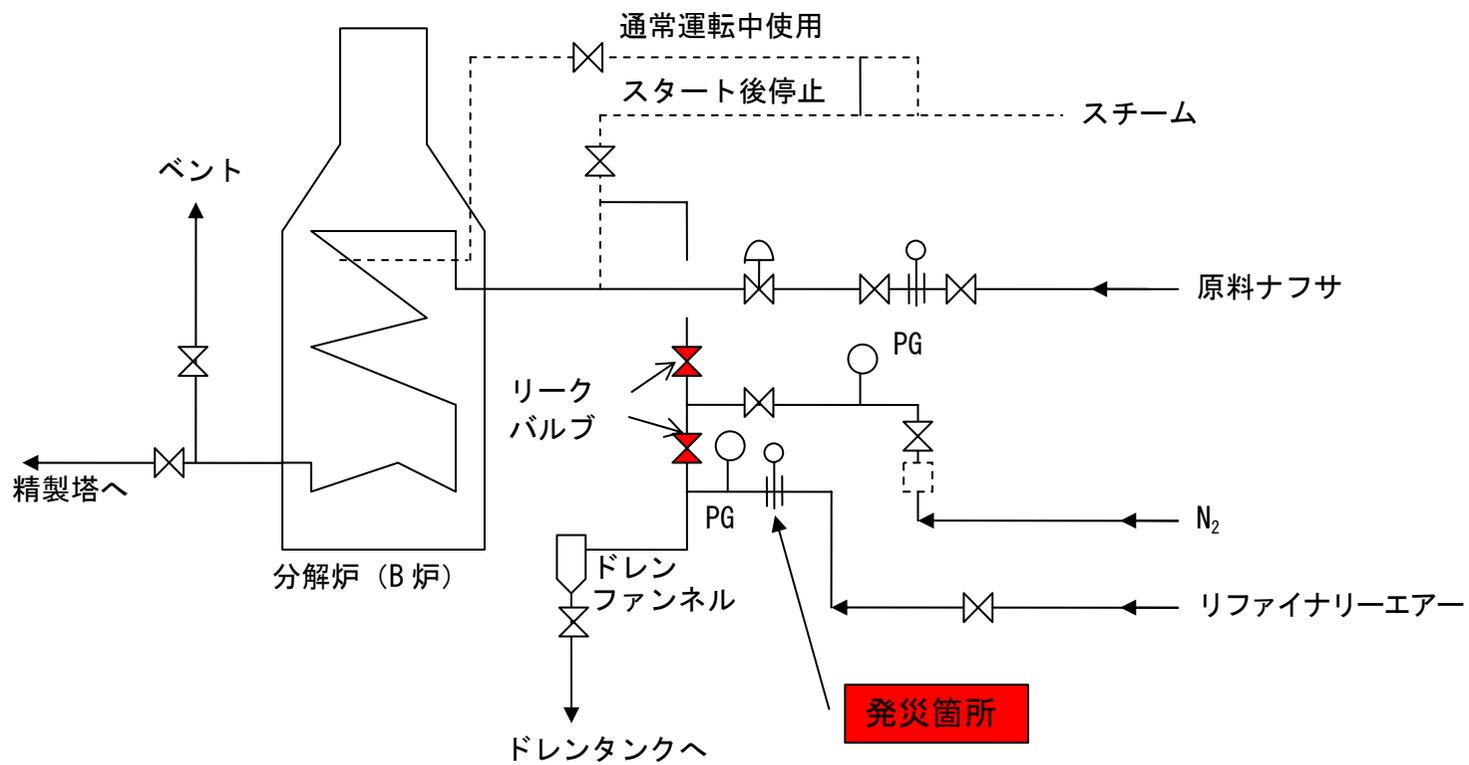
発災箇所の配管系統概略図
