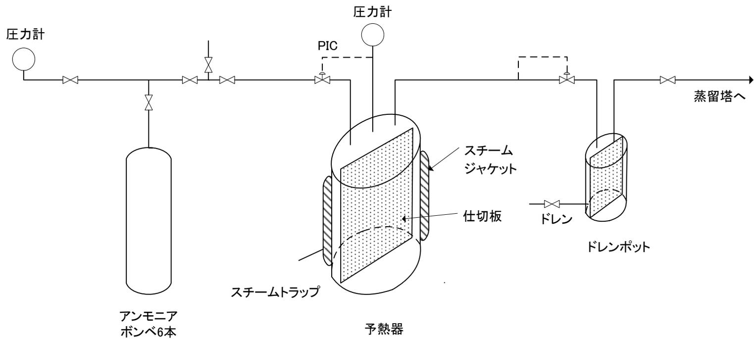
アンモニア注入設備概略系統図
