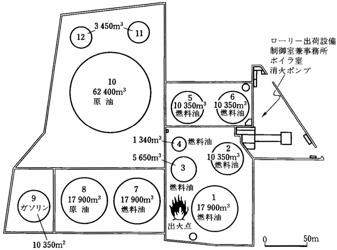
図 油槽所配置図
