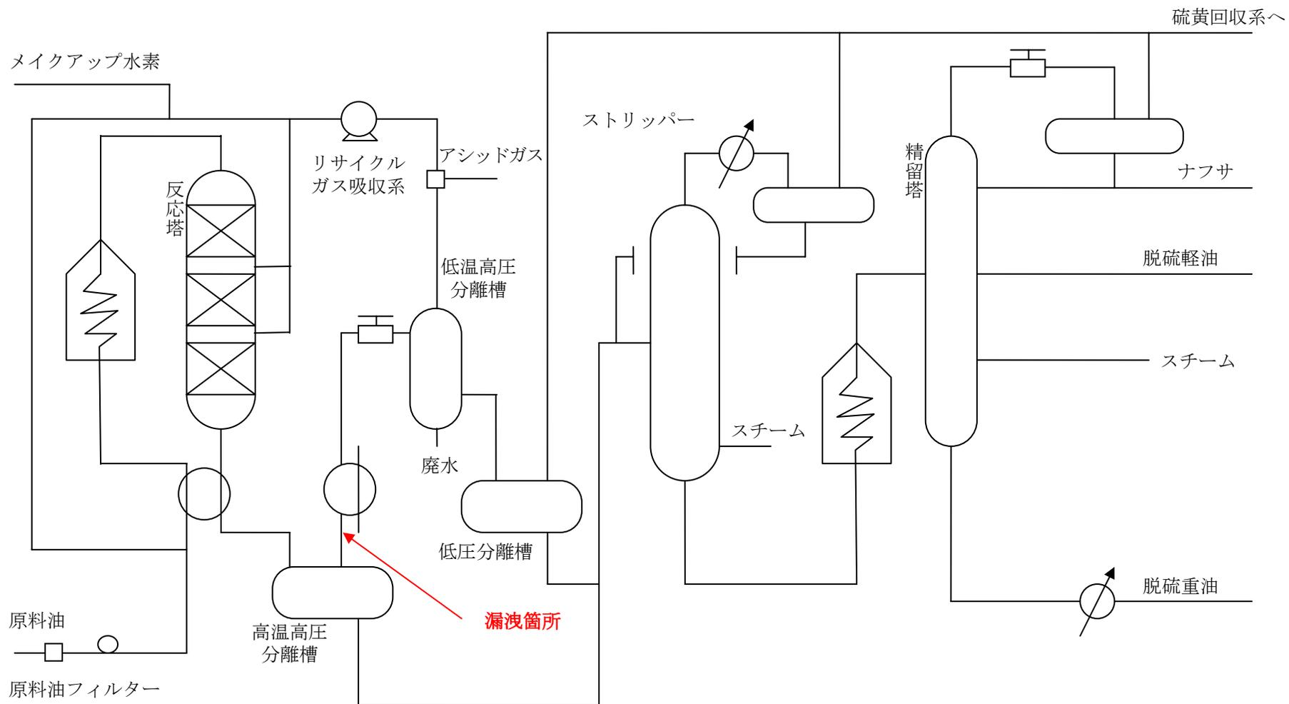
図 重油直接脱硫装置系統図
