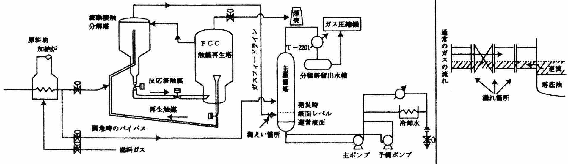
図 流動接触分解装置概略フロー
