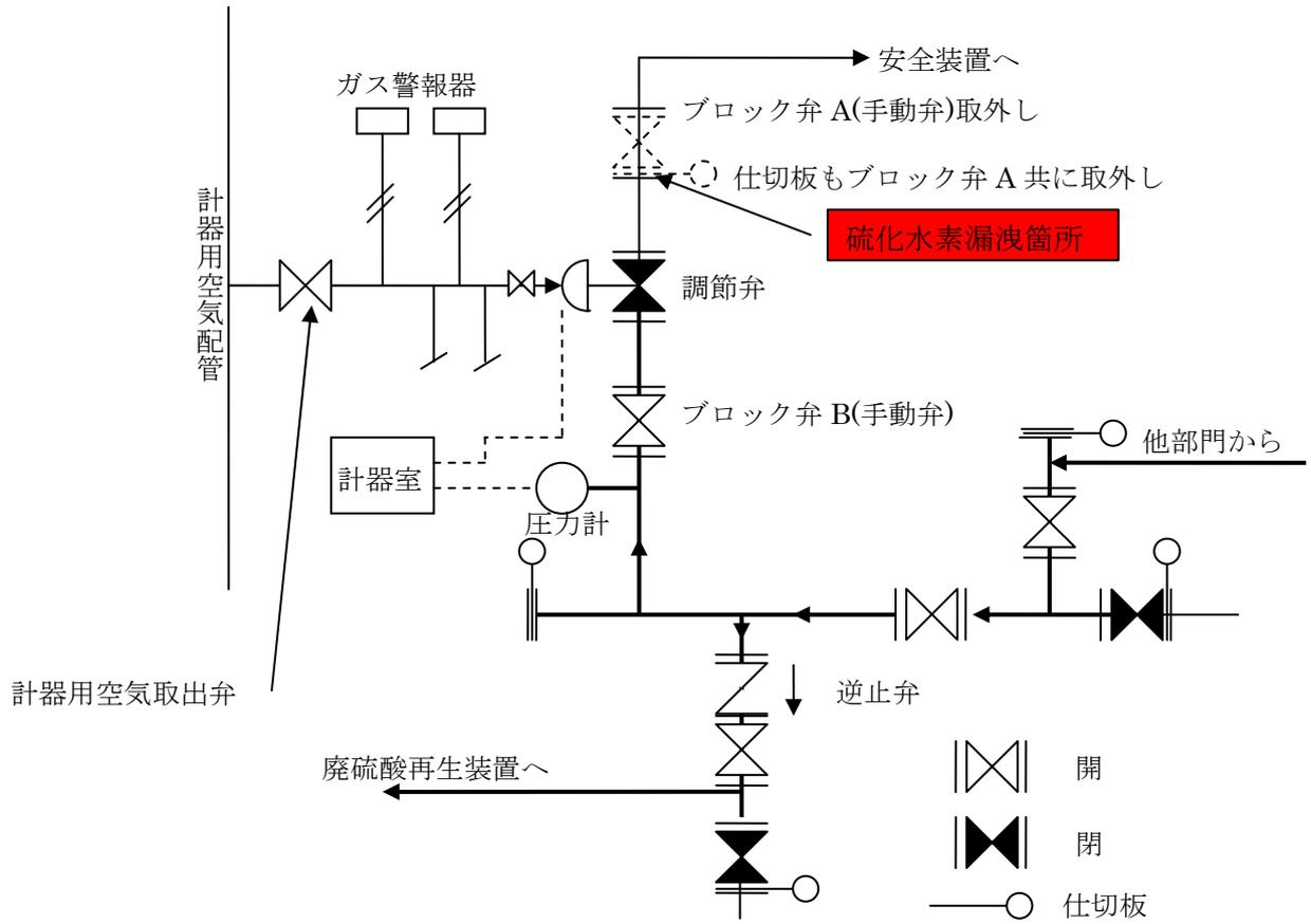
注：太線は硫化水素ガスを B 号地 MEA 再生部門より、C 号地廃硫酸再生装置へ送気するために使用した配管径を示す。
