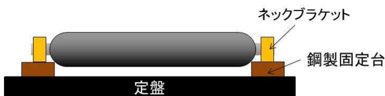
図 5 打振試験時の容器のネックマウント方式固定（イメージ）
