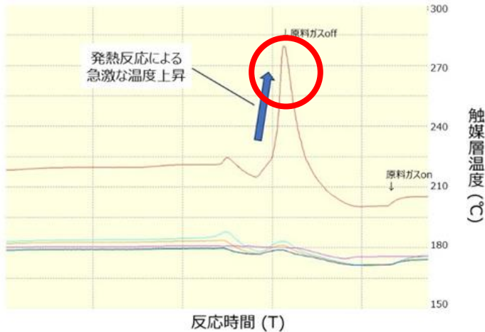
FTベンチ試験機における触媒層昇温時に発生した熱暴走の一例
