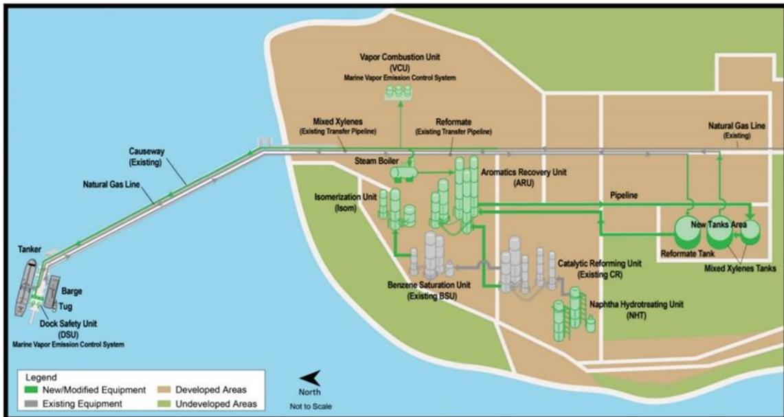
図 3. Anacortes 製油所の Clean Products Upgrade Project (CPUP) 新設&改造装置
