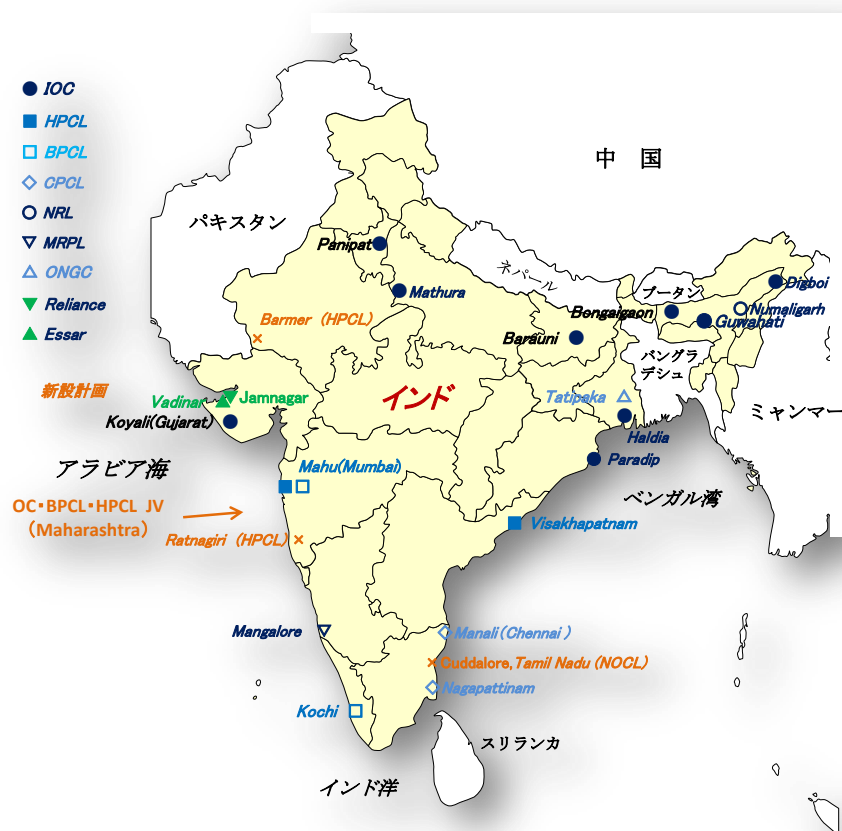
図 12. インドの製油所の配置図
