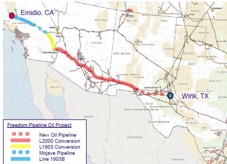
図2. 「Freedom パイプライン」設置ルートと既存パイプライン転用区間 (出典：KMP のHP 資料)
