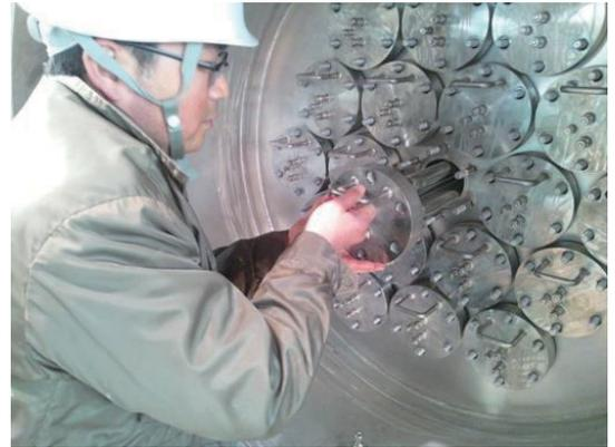
図3 熱交換器一体型分離膜モジュール (左図: 全体図 右図: ユニット装着の様子)
