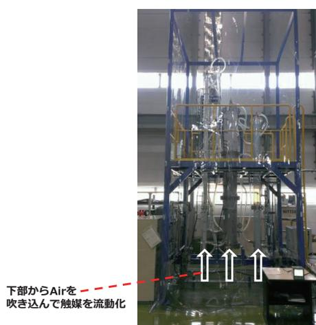
図7 大型コールドフロー装置の外観
