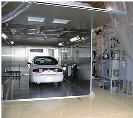
給油 SHED 設備
