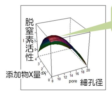
設計した脱窒素触媒の推定性能
