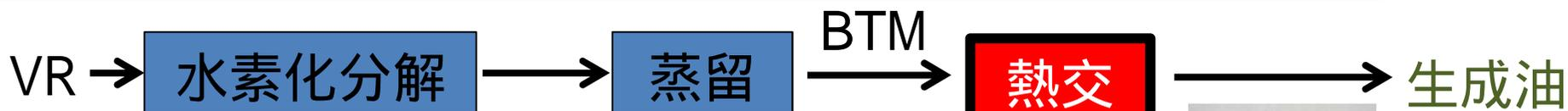
ファウリングの指標である熱交の差圧上昇速度と生成油のセジメント試験（150 熱ろ過）の相関は高い
