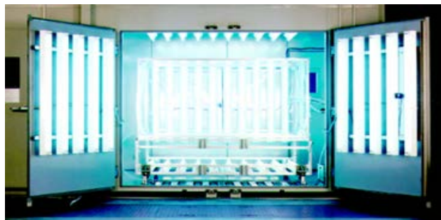
実験装置 (スモッグチャンバシステム)
